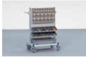
Klein und kompakt präsentieren sich die Transportwagen von ihrer wendigen Seite. Dieser Bereitstellwagen kann zur Materialbereitstellung oder zum Abtransport der Fertigungsstücke am Arbeitsplatz positioniert werden.
