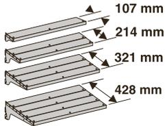
in 4 Tiefen lieferbar, 1 - 4 Stück auf einem Trägerpaar angeordnet, neigbar  $-16^{\circ}/+10^{\circ}$ , Abschluss mit vorderer Anschlagleiste möglich
